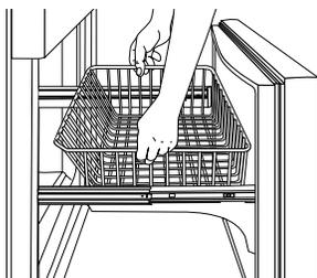
5. Enlever les supports de panier des rails du tiroir. Pousser les agrafes vers l'intérieur hors des rails du tiroir pour déclencher les supports de panier. Soulever les supports de panier hors des rails de tiroir.
