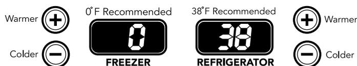
**IMPORTANT :** Lorsque l'appareil est sous tension, l'afficheur indique la température réelle du compartiment.
