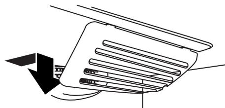
3. Enlever l'écran de protection et remplacer l'ampoule grillée avec une ampoule pour appareil ménager de pas plus de 40 watts.
