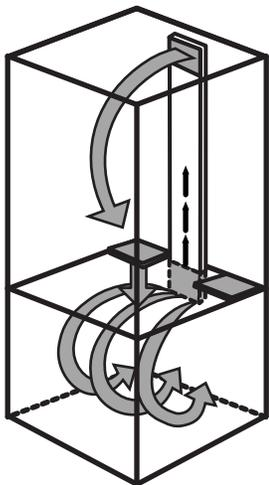
Ne pas bloquer les ouvertures d'aération. Si les ouvertures d'aération sont bloquées, le flux d'air est obstrué et des problèmes de température et d'humidité peuvent survenir.
